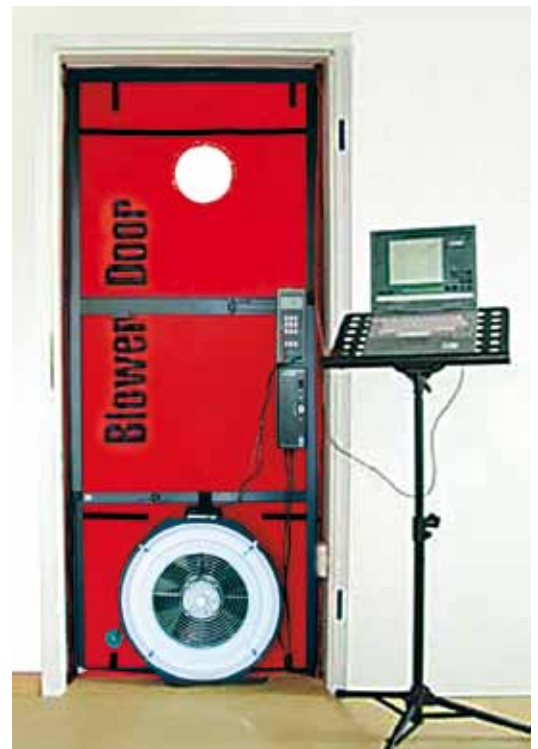
Bild 19: Luftdichtheitsmessung nach der „Blower-Door-Methode“
