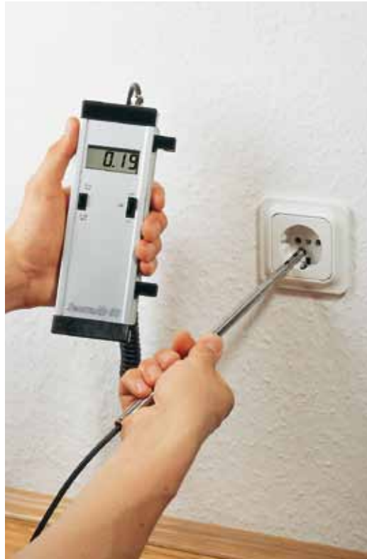
Bild 21: Leckageortung und Messung der Luftundichtheit mit Thermoanemometer
